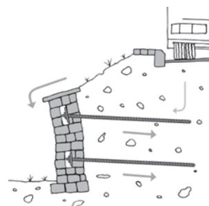
Der Einbau von Bodennägeln bewehrt das Erdreich und stabilisiert den Mauer Kern. Eine Vergütung stellt den Kraftschluss im Mauerwerk wieder her.
