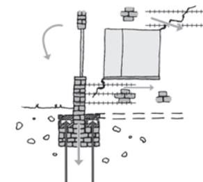
Die Vernadelung der Risszonen in den Mauerwänden stabilisiert das Bauwerk. Durch Kleinbohrpfähle werden die Lasten sicher in tragfähigen Baugrund abgeleitet.
