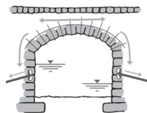
Der Einbau von Mauerwerksnadeln verstärkt den Brückenbogen. Bodennägel sichern die Widerlager und leiten Lasten sicher in den Baugrund.
