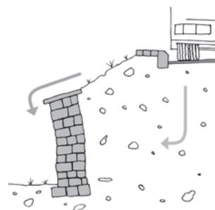
Durch Lasterhöhung, Veränderung der Bodeneigenschaften und Verwitterung des Mauerwerks verliert das Bauwerk seine Stützwirkung.
