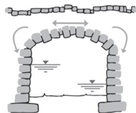
Durch Anstieg der Verkehrsbelastung, Verschleiß von Abdichtung und Mauerwerk kommt es zu Verformungen und Ausbrüchen.
